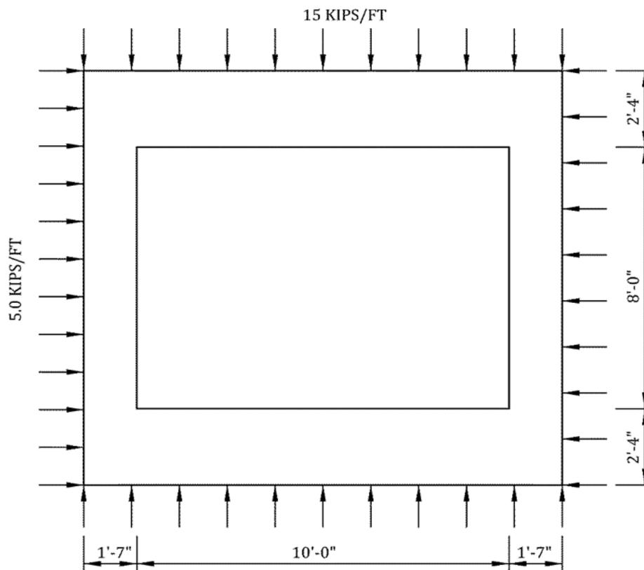
Figure D-6. Rectangular conduit
