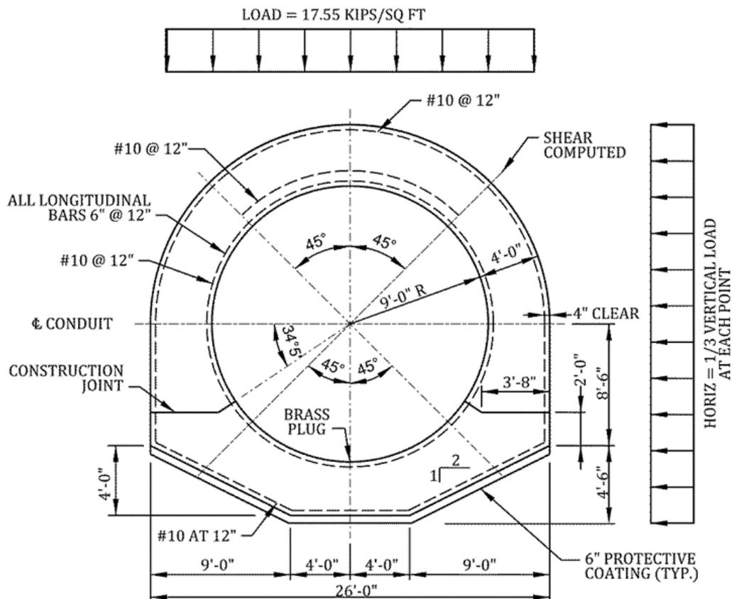
Figure D-7. Circular conduit
